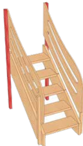
Treppe mit Geländerfüllung, unten offen
