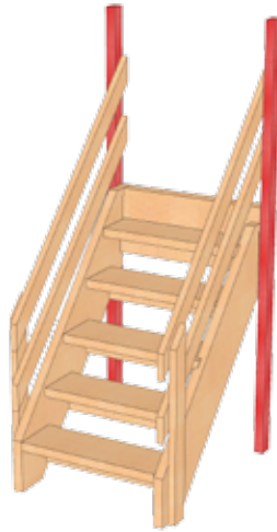
Treppe mit Handlauf, unten offen
